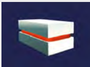
4. La polimerización se realiza por la mezcla íntima de ambos materiales que componen el adhesivo.
