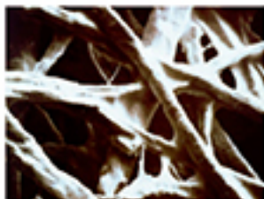
Las fibras de celulosa impregnadas bajo el microscopio.
