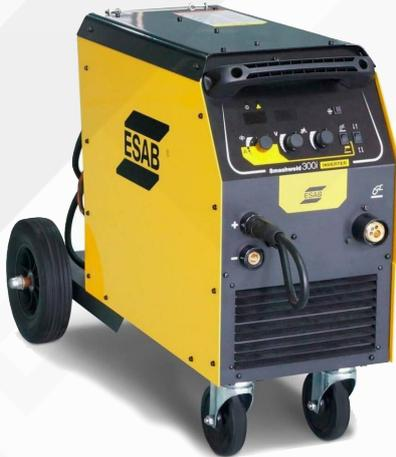
Su tecnología inversa la hace ligera, económica y versátil con la potencia ideal para los trabajos más diversos. Para un ciclo de trabajo hasta 200A @ 60% para soldadura con electrodos y hasta 250A @60% para soldadura MIG.
