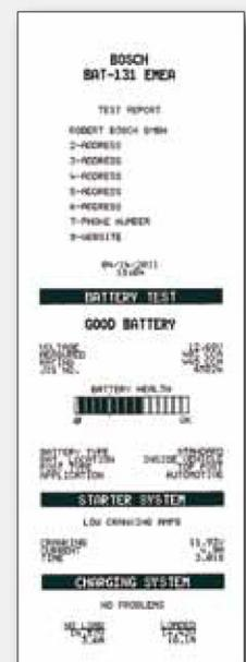
BAT 131 con impresora integrada. La impresión gráfica incluye resultados detallados de la prueba.
