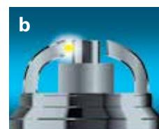
Electrodo de masa perfilado – electrodo central.
