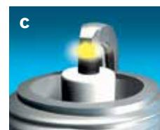
Electrodo lateral – superficie de aislador – electrodo central.
